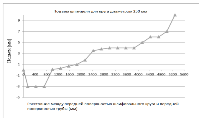
Рис. 7. Теоретический ход подъема шпинделя для круга диаметром 250 мм.
